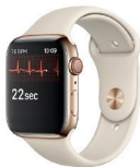
Hình 3. Đồng hồ thông minh có khả năng đo và cảnh báo nhịp tim bất thường (Nguồn: https://www.forbes.com/ )
